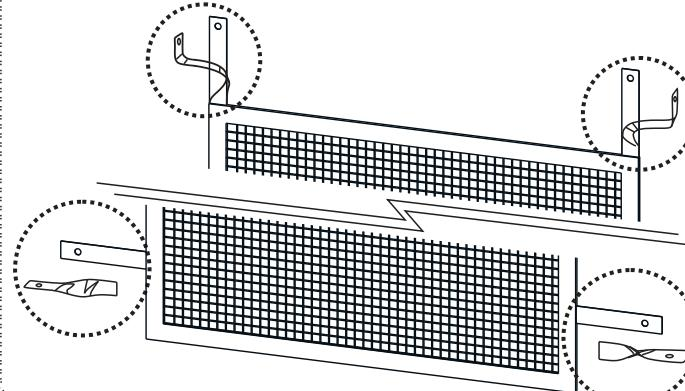
**5. Colocar el mariposero fijando los anclajes inferiores a las bases plásticas de los extremos, con los tornillos autoperforantes.**
