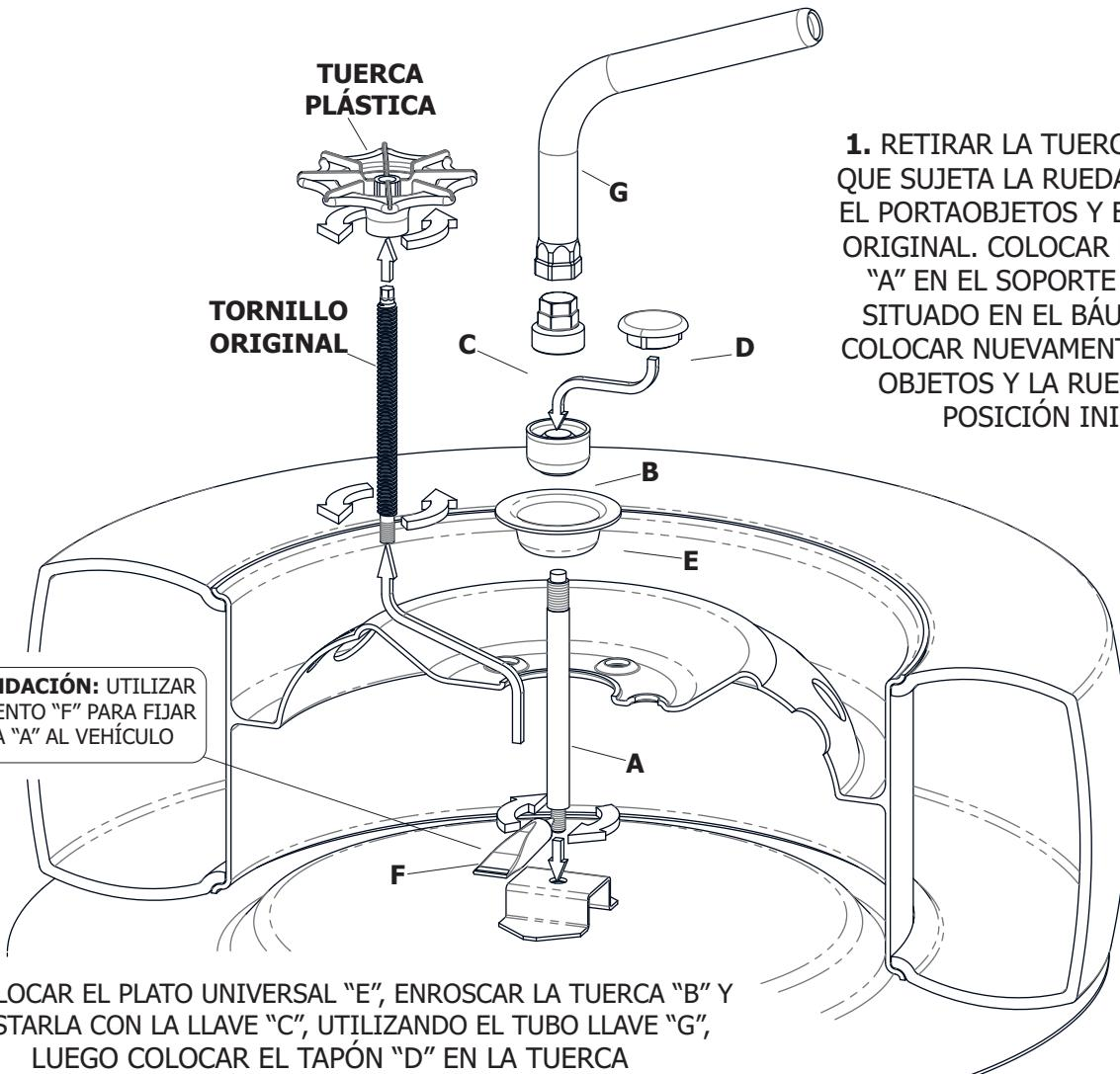
1. RETIRAR LA TUERCA PLÁSTICA QUE SUJETA LA RUEDA, LA RUEDA, EL PORTAOBJETOS Y EL TORNILLO ORIGINAL. COLOCAR EL SOPORTE "A" EN EL SOPORTE ORIGINAL SITUADO EN EL BÁUL Y LUEGO COLOCAR NUEVAMENTE EL PORTA OBJETOS Y LA RUEDA EN SU POSICIÓN INICIAL
