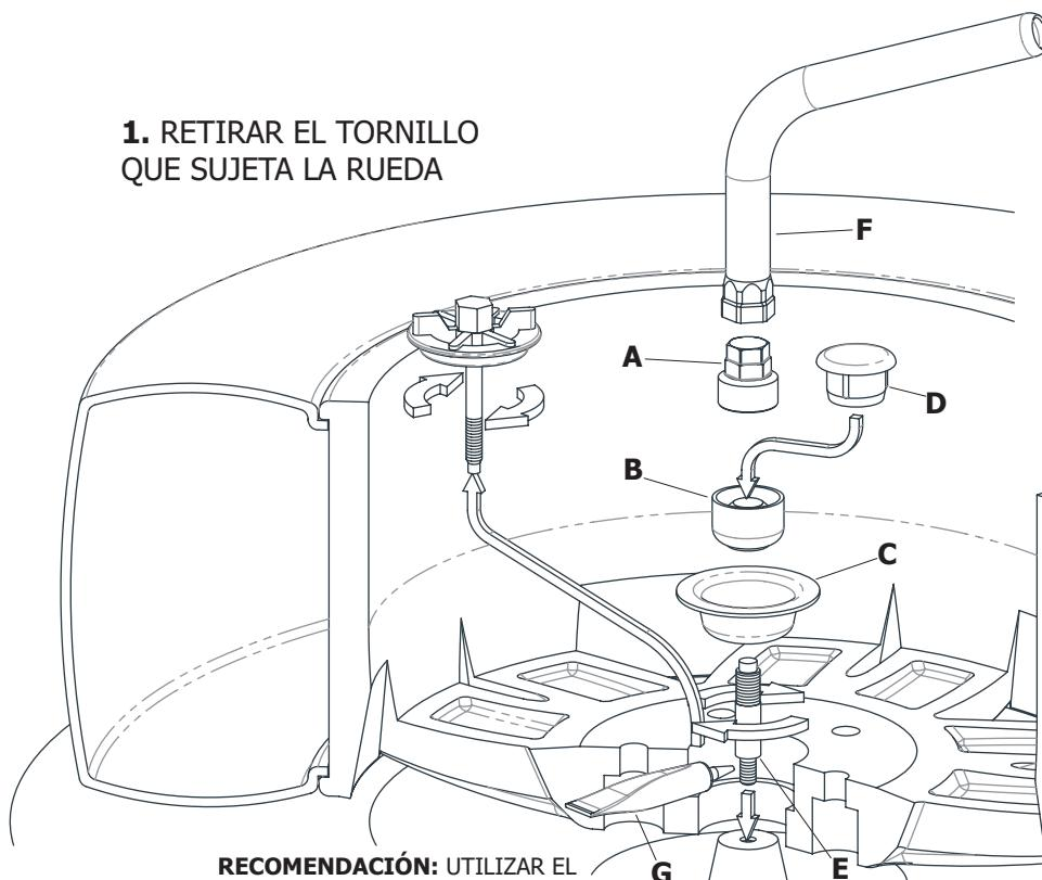
**RECOMENDACIÓN:** UTILIZAR EL PEGAMENTO "G" PARA FIJAR LA PIEZA "E" AL VEHÍCULO
