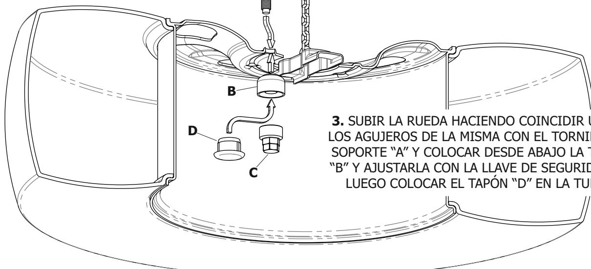
3. SUBIR LA RUEDA HACIENDO COINCIDIR UNO DE LOS AGUJEROS DE LA MISMA CON EL TORNILLO DEL SOPORTE "A" Y COLOCAR DESDE ABAJO LA TUERCA "B" Y AJUSTARLA CON LA LLAVE DE SEGURIDAD "C". LUEGO COLOCAR EL TAPÓN "D" EN LA TUERCA
