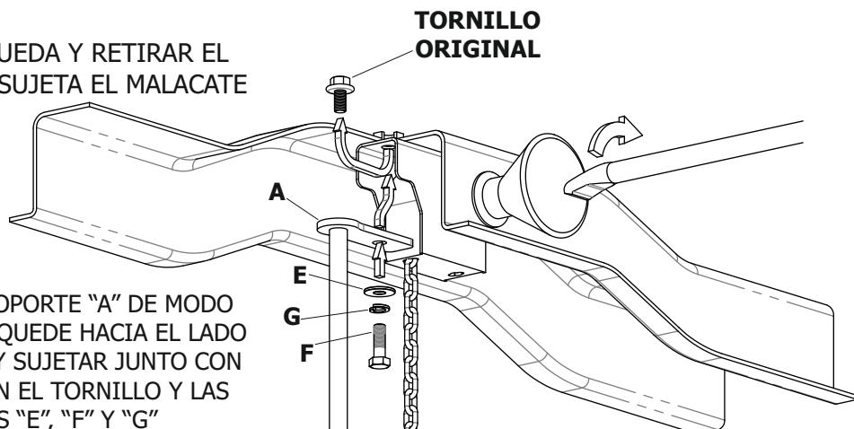
2. COLOCAR EL SOPORTE "A" DE MODO QUE EL TORNILLO QUEDE HACIA EL LADO DEL CONDUCTOR Y SUJETAR JUNTO CON EL MALACATE CON EL TORNILLO Y LAS ARANDELAS "E", "F" Y "G"
