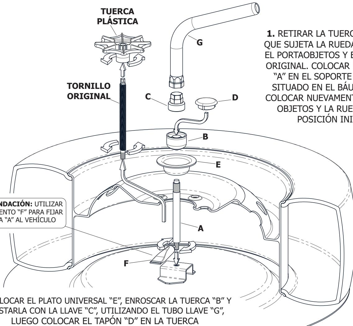
2. COLOCAR EL PLATO UNIVERSAL "E", ENROSCAR LA TUERCA "B" Y AJUSTARLA CON LA LLAVE "C", UTILIZANDO EL TUBO LLAVE "G", LUEGO COLOCAR EL TAPÓN "D" EN LA TUERCA
